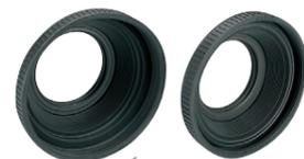
二段階に折りたためる設計です。標準レンズから広角28mmレンズまでをカバーする、広角レンズ系のゴム製フードです。フードを全部引き伸ばしたときの写角は約64度、標準レンズから広角35mmレンズに使用できます。また一段折りたたむと写角は約76度、広角28mmレンズに使用できます。
